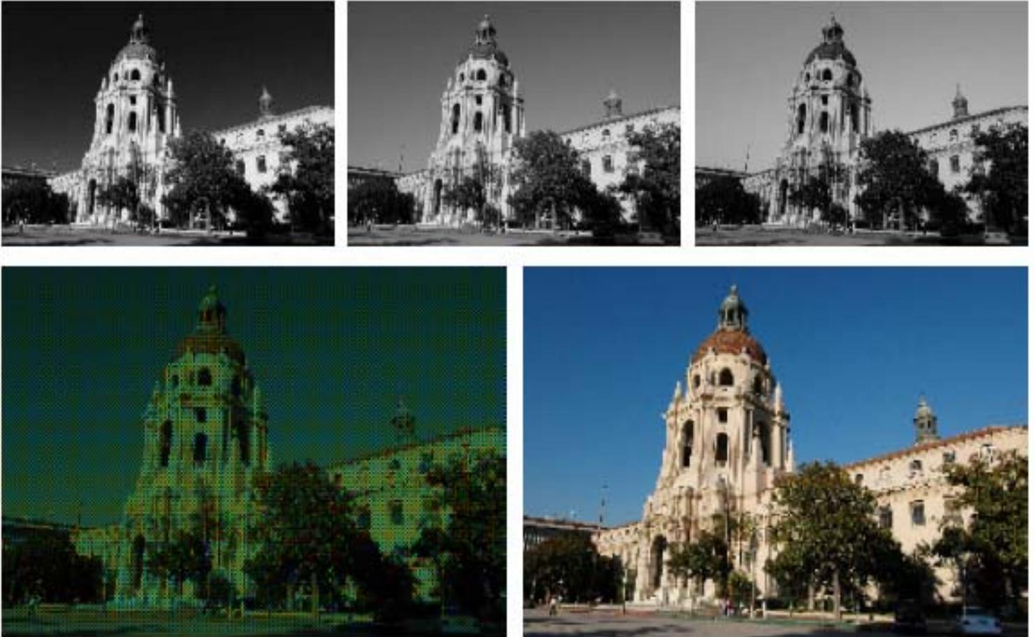
On sait voir cela sur cette image. En haut les trois images perçues en monochrome et en bas à gauche la répartition couleur sur le chip. A droite en fin l'image reconstruite en couleur par le logiciel.
